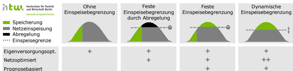
Bild 32 Schematische Darstellung und Charakteristik verschiedener Betriebsstrategien für PV-Speichersysteme.
