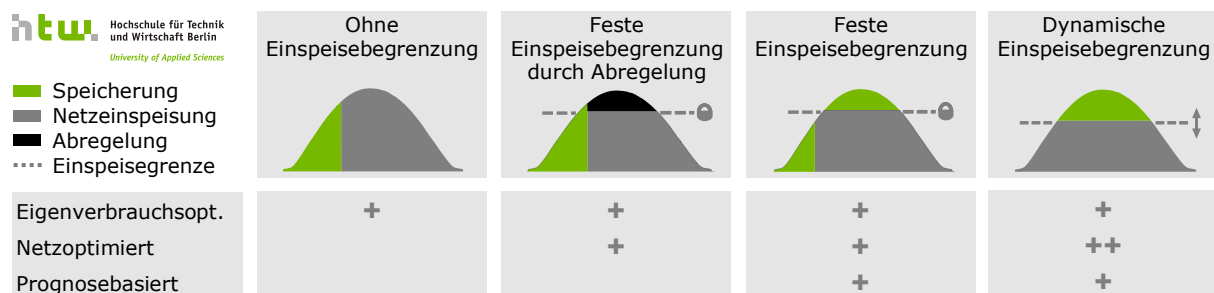
Bild 3 Schematische Darstellung und Charakteristik verschiedener Betriebsstrategien für PV-Speichersysteme
