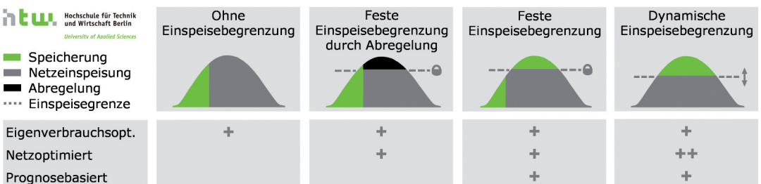
Abbildung 2: Schematische Darstellung und charakteristische Eigenschaften verschiedener Betriebsstrategien für PV-Speichersysteme [1].
